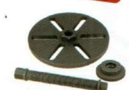
5246 萬用型日系卡車 軸拔卸器 JAPANESE TRUCK UNIVERSAL AXLE EXTRACTOR
